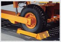
チェーンと車輪止めで機体を固定。万一外れても2段式ランディングギアが機体全体を支え、転倒を防止。また、タイヤにはパンクの心配のないユニークタイヤを使用しています。
