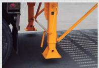
機体先端をコンテナ床面に載せ掛け、ランディング ギア(前脚)を浮かせることで、コンテナの浮き 沈みと同調させ荷重により生じる段差を解消。 フォークリフトがスムーズに走行できます。
